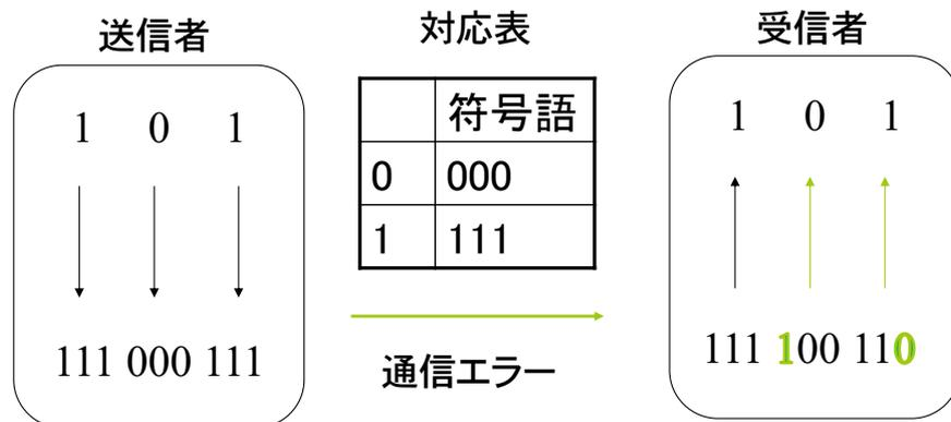
通信エラーは、通信の途中でビットが反転する(0が1に化ける,1が0に化ける)形で現れるとします。
